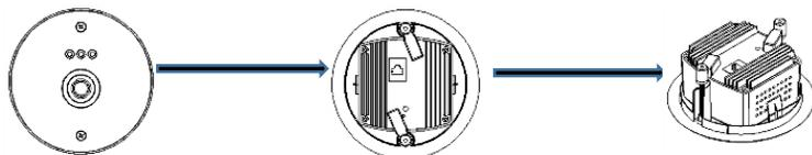
使用附赠搭配之嵌入式支架。将设备插入支架并旋转夹片固定，插入时设备指示灯方向朝向支架。
