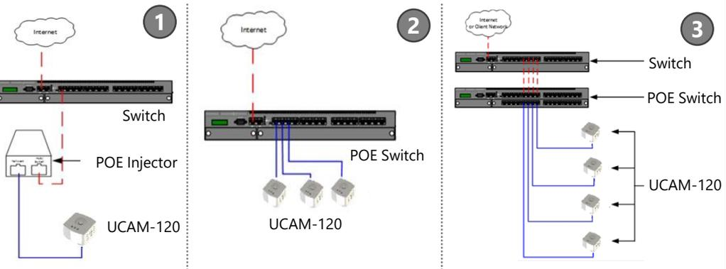
根據安裝現場的實際情況及安裝的設備數量從三種網路架構中選擇使用架構連結
