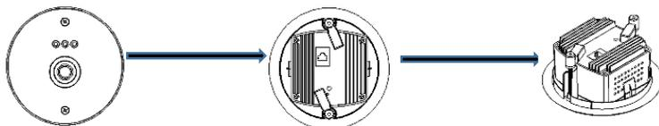
使用附贈搭配之嵌入式支架。將設備插入支架並旋轉夾片固定，插入時設備指示燈方向朝向支架。
